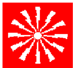
PULSANTE DI ALLARME ANTINCENDIO
